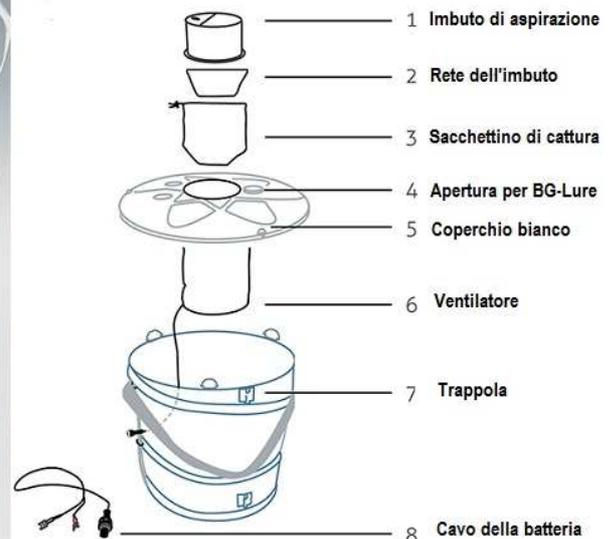
Il kit BG-Sentinel 2 comprende un imbuto di aspirazione, rete dell'imbuto, 2 sacchettini di cattura, il coperchio della trappola, cilindro interno con ventilatore attaccato, il corpo della trappola, il cavo della batteria e una cartuccia di BG LURE adescante della durata di 5 mesi.
